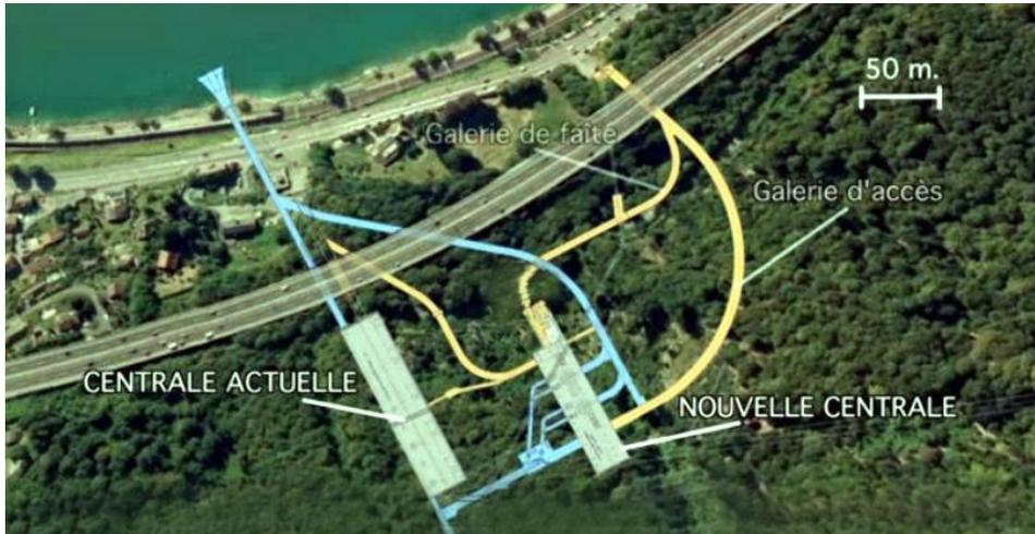
page-turbinage tel que Veytaux, la particularité est que l'eau va dans les deux sens, soit elle descend du lac de l'Hongrin en mode turbinage ou elle monte dans ce même lac lorsqu'elle est prélevée du Léman en mode pompage.
